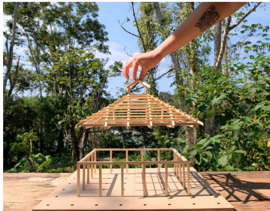
Maqueta desmontable de la propuesta 8 x 10 metros. Fotografía: Comunal.
